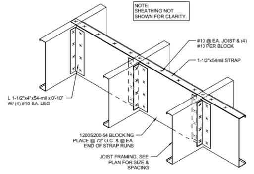
19 JOIST SOLID BLOCKING DETAIL
