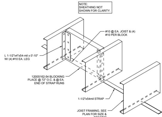
14 JOIST BLOCKING DETAIL
